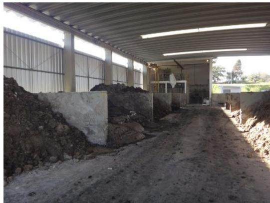
Figura 6 – Local onde ocorre a centrifugação do lodo e o tratamento com cal
